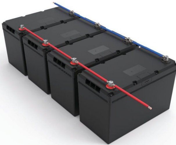
4 stuks x 12,8V100ah parallel Figuur 3 Voorbeeld van een 4P-configuratie
