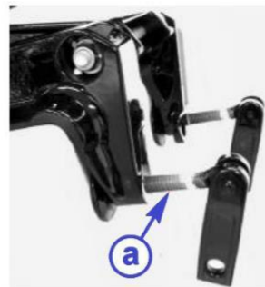
a - smeernippels stuurkolom b - stuurfrictie-instelling
